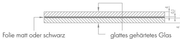
Standard-VSG/ESG geklebt und gehärtet,
