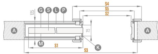
Breite des Kastens vor der Beplankung mit GK-Platten: 100 mm
