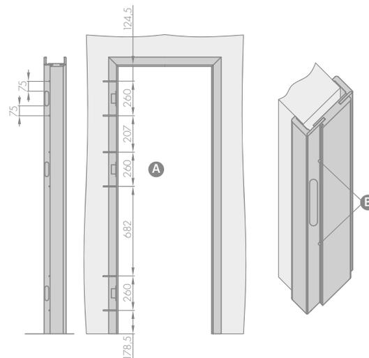
**A** Öffnungen ausführen für Metallschrauben mit einer Länge von mind. 80 mm x 6mm.
