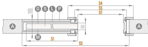
Breite des Kastens vor der Beplankung mit GK-Platten: 75 mm
