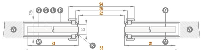
Breite des Kastens vor der Beplankung mit GK-Platten: 100 mm
