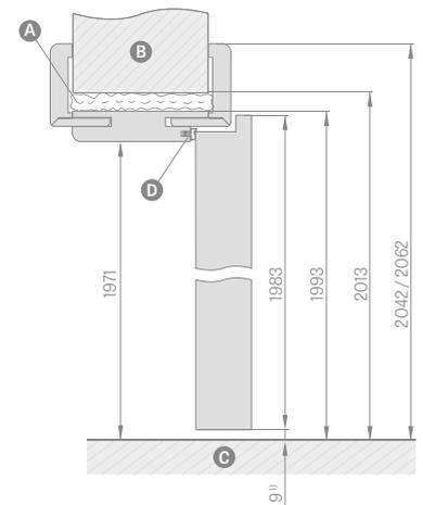
**A** Schaum **B** Mauer **C** Boden **D** Anschluss
