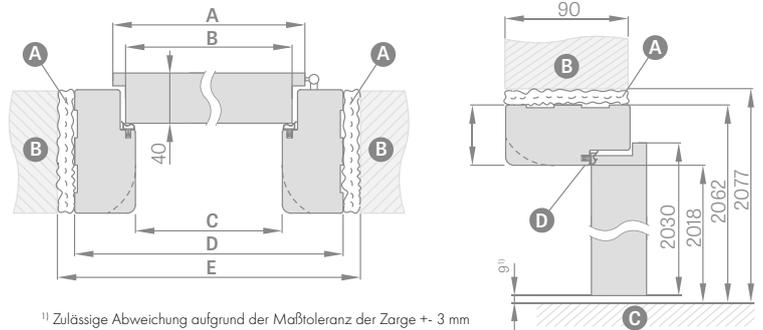
**A** Schaum **B** Mauer **C** Boden **D** Gummi Dichtung
