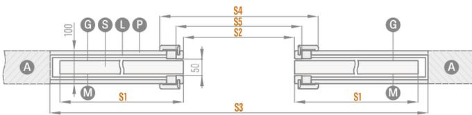
Breite des Kastens vor der Beplankung mit GK-Platten: 75 mm
