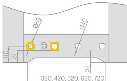
Hülsen aus Metall mit viereckigem und rundem Querschnitt:
